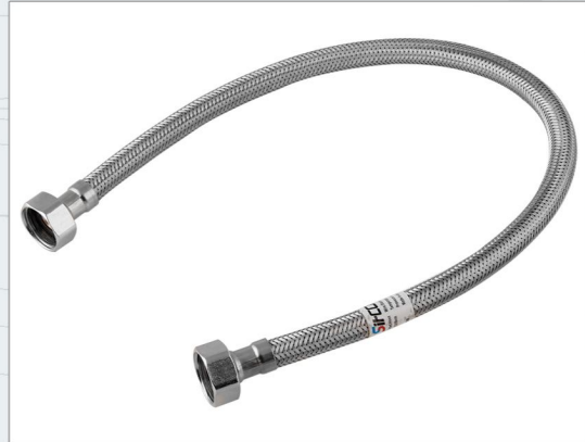
Two Head To Hose Length: 30, ..., 100 cm Size: 1/2" x 1/2" Dia: 12 mm Material: Wire S.S/ Aluminum شیلنگ دو سر مهره طول: ۳۰ الی ۱۰۰ سانتی متر سایز: ۱/۲ x ۱/۲ اینچ ضخامت: ۱۲ میلی متر متریال: استیل یا آلومینیوم
